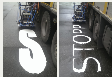
Bild 2. Test av tryckregleringens funktion med avseende på utfyllnad.
